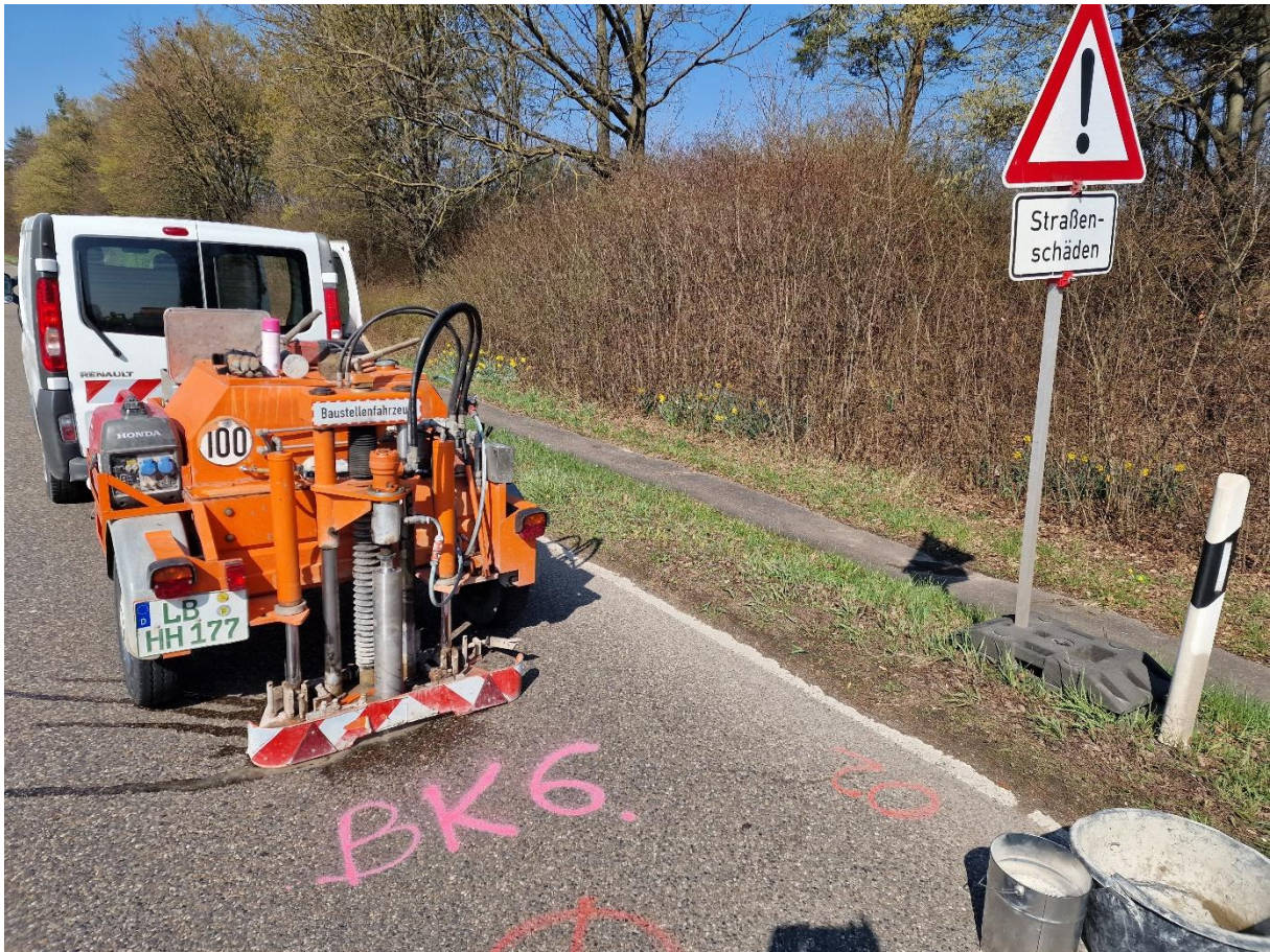
Foto Nr. 17: Entnahmestelle Bohrkern 6
